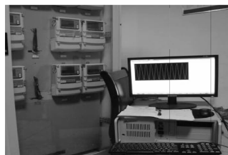
(b) 绕组变形监测系统现场接线图
