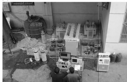
(b) 三相变压器绕组变形实验室研究平台
